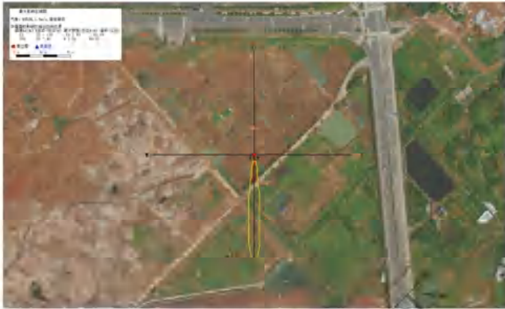
图 6.2-3 最不利气象条件下 HCl 泄漏扩散最大影响区域图
