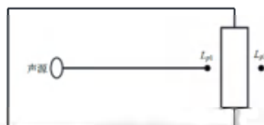
图 4.4-1 室内声源等效为室外声源图例
