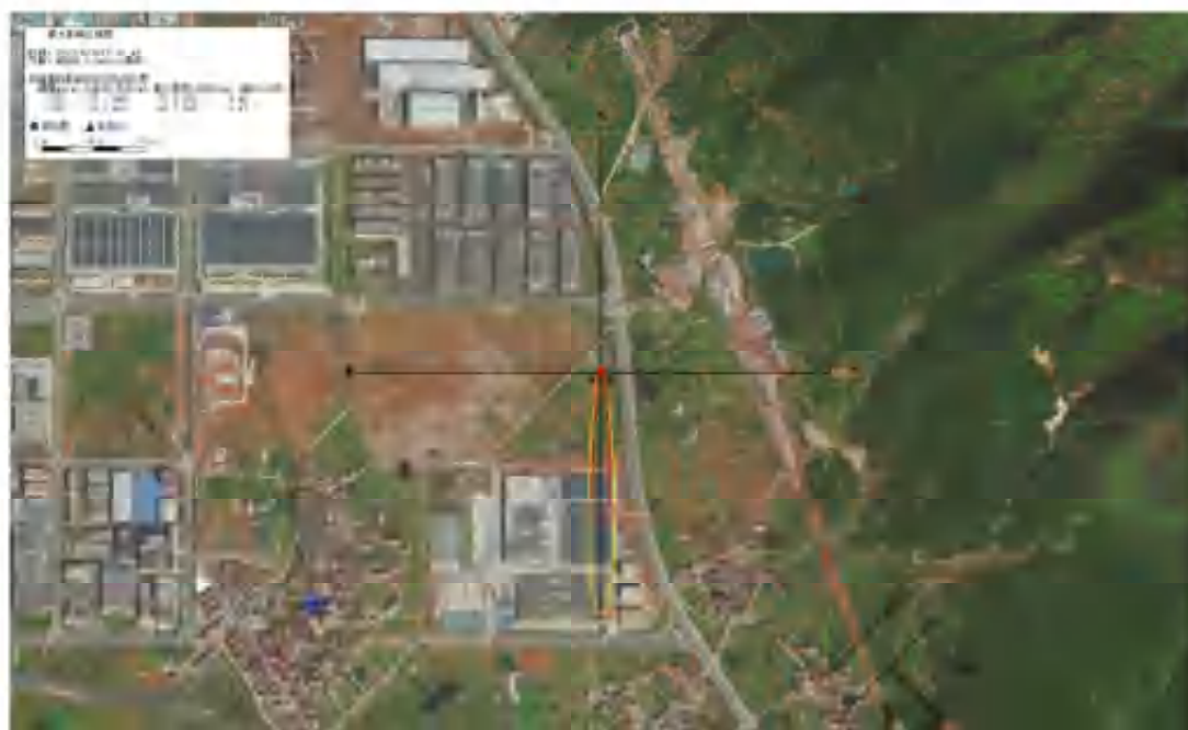
图 6.2-12 常规气象条件下硅烷泄漏扩散最大影响区域图
