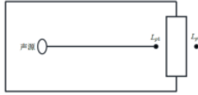
图 4.3-1 室内声源等效为室外声源图例
