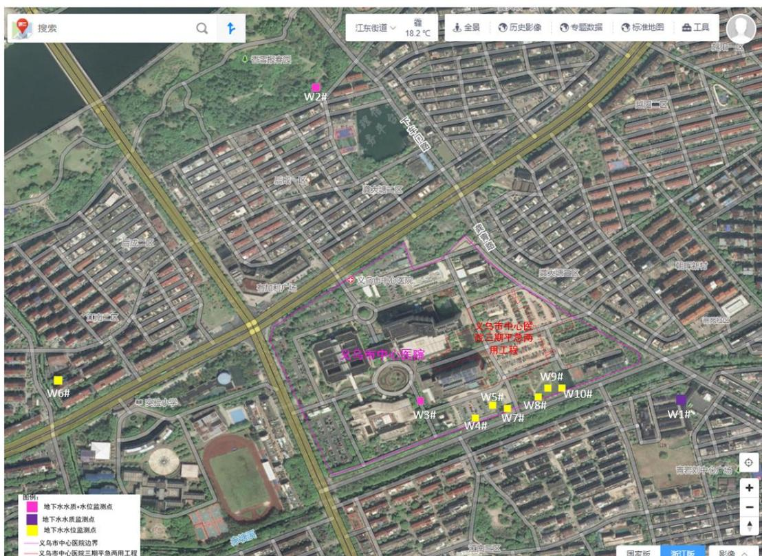
图 5.2-3 地下水水质、水位监测点位示意图
