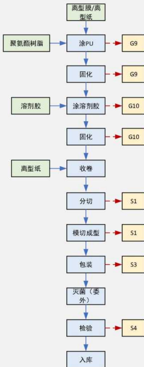
图2.6-4透明敷料生产工艺流程图及产排污环节
