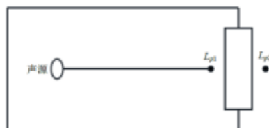
图 4.8-2 室内声源等效为室外声源图例
